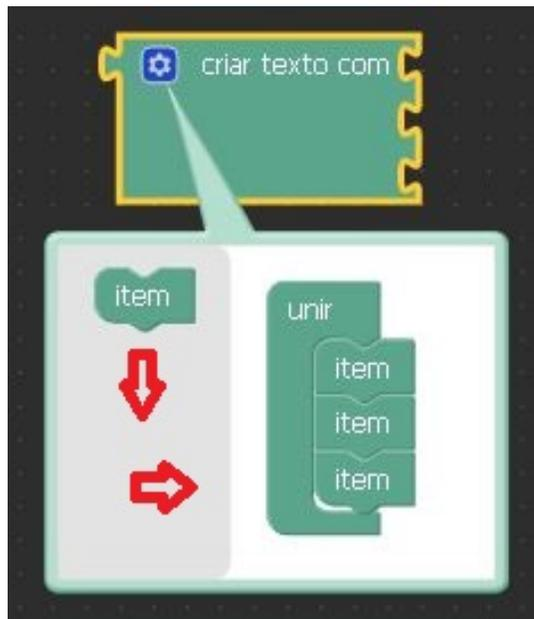
É possível adicionar a quantidade de itens/parâmetros necessária através das configurações do componente, como pode-se ver na figura acima.
