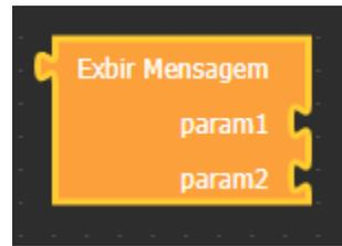
Figura 2.3 - Bloco da função com os parâmetros de entrada
