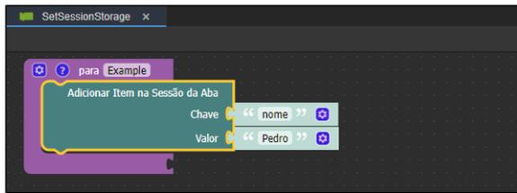
Figura 2 - Exemplo de uso do bloco Adicionar Item na Sessão da Aba
