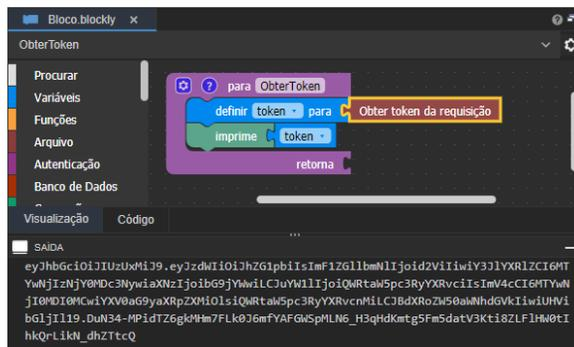
Figura 1 - Imprimindo o token da requisição
